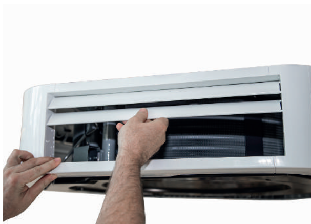
Fig. 31: Removing fins
